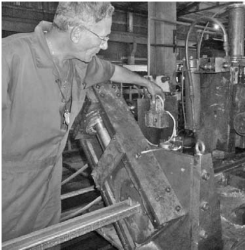
La nueva cortadora de purlings eliminó el ruido, optimizó el acabado y permitió duplicar la producción en serie. FOTO DEL AUTOR
