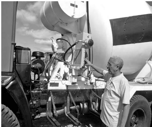
La eliminación del motor auxiliar para mover la hormigonera, evita el gasto de 40 litros de combustible diarios, explica Carlos Oscar Valdés.
