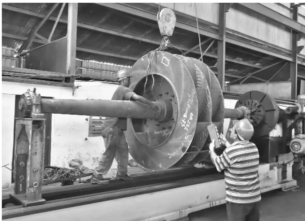
Whendis Álvarez (a la izquierda), comprueba el funcionamiento del rotor del central Brasil.
