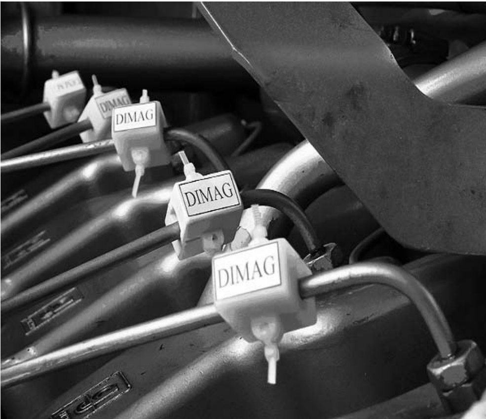
Los magnetizadores se colocan en diferentes puntos, como los inyectores y las tuberías de alimentación. FOTO: CORTESÍA EMPRESA DE COMPONENTES ELECTRÓNICOS
