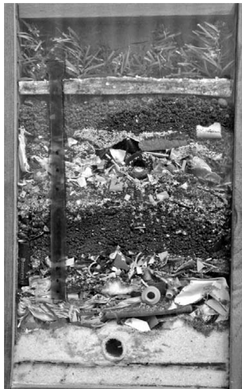
La imagen muestra la disposición de las capas del nuevo relleno sanitario, una de sus peculiaridades. De abajo hacia arriba: capa de arcilla, geomembrana, sistema de recolección de lixiviados, capas de desecho y relleno, sistema de desgasificación.
