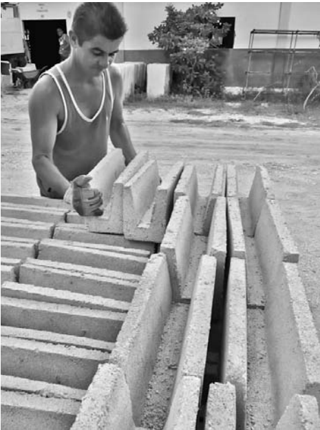
Los Bloques U tienen 40 centímetros de longitud. Entre enero y septiembre fabricaron más de 5 300 unidades, es decir, lo suficiente para unas 86 viviendas. FOTO DEL AUTOR
