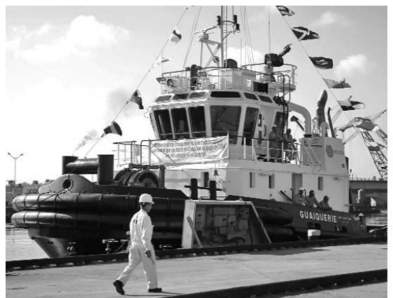
El navío posee una propulsión azimutal (gira 360 grados sobre su eje), una capacidad de empuje de 57 toneladas y una potencia de 4 700 caballos de fuerza.
