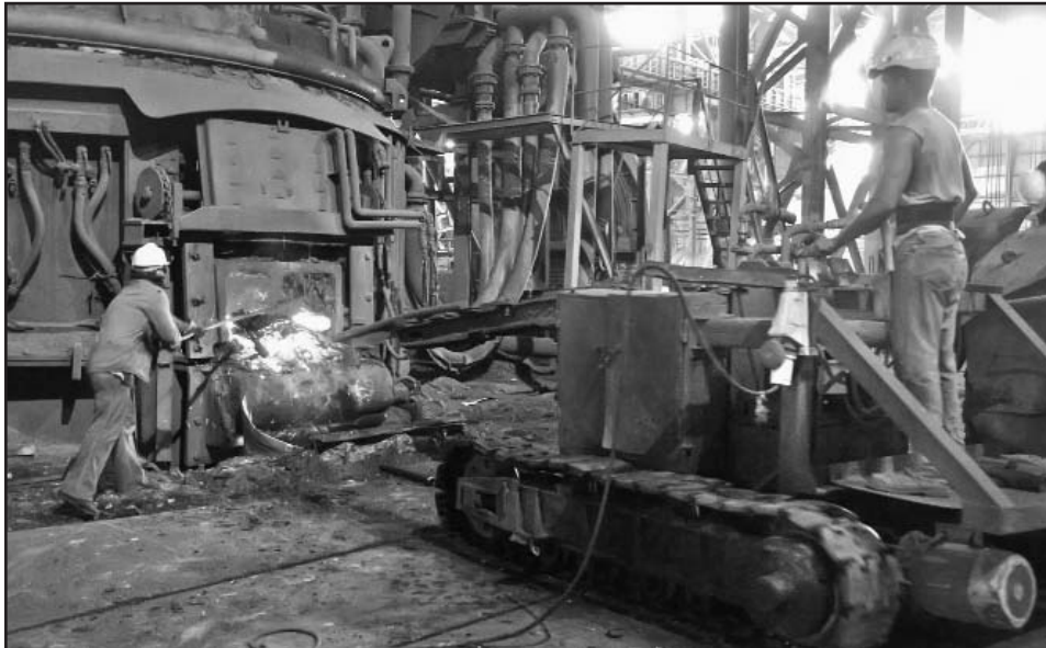
El uso de la energía química en el horno eléctrico, y el empleo de la lanza supersónica permitieron, en el 2010, un ahorro de 25 kiloWatts por cada tonelada de acero líquido.
