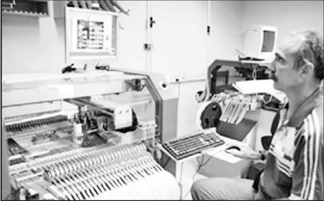
El ICID cuenta con tecnología de avanzada para el montaje automático de componentes electrónicos, esencial para sus producciones. Foto: Antonio Pons Beato
