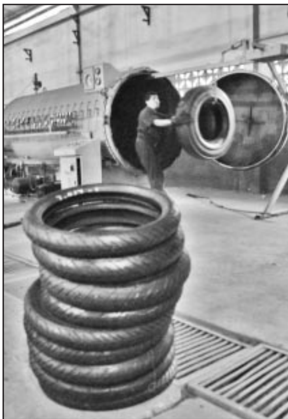
También recuperan neumáticos de moto con la aplicación de la tecnología de recape en frío.
