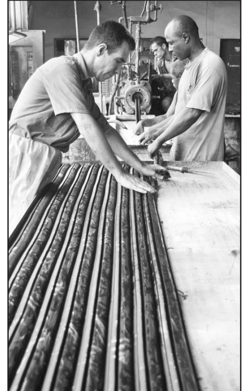
Uno tras otro, de esta extrusora salen los perfiles para reconstruir ómnibus Girón.
