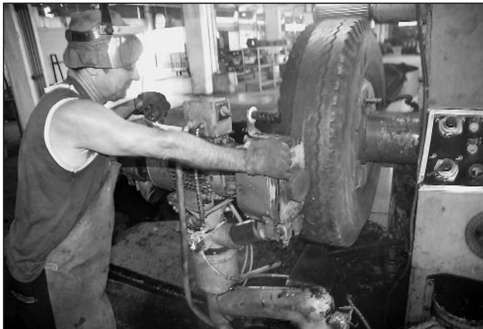
Este operario raspa la banda de rodamiento remanente en el casco, para adherirle una nueva. Mediante el recape, los neumáticos pueden volver a la vida hasta tres veces.
